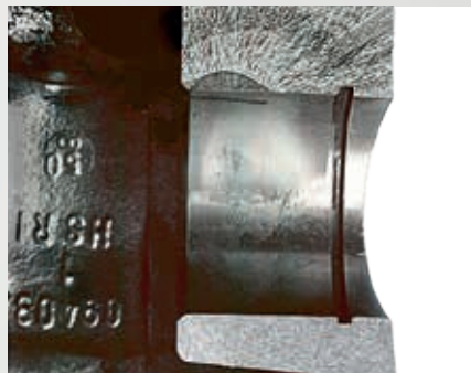
Fig. 3 Sección transversal de una bancada de bulón
